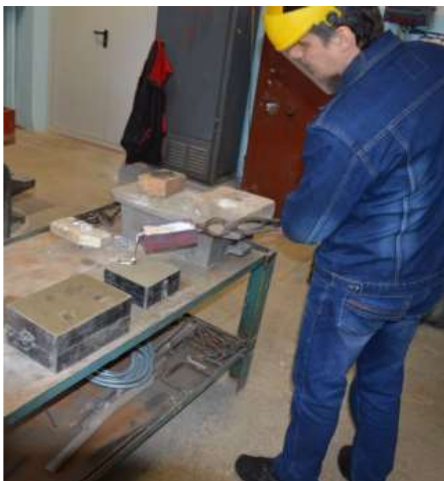
Рисунок 2 – Заведующий лабораториями В.Ю. Белозеров делает отливку алюминия в песчаную смесь опоки (а), студент А.А. Галынский формует песчаную смесь в опоку для отливки модели алюминия (б).
