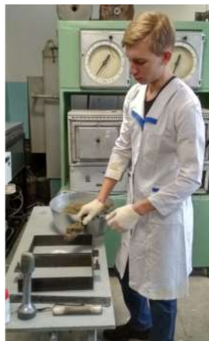
Рисунок 2 – Заведующий лабораториями В.Ю. Белозеров делает отливку алюминия в песчаную смесь опоки (а), студент А.А. Галынский формует песчаную смесь в опоку для отливки модели алюминия (б).
