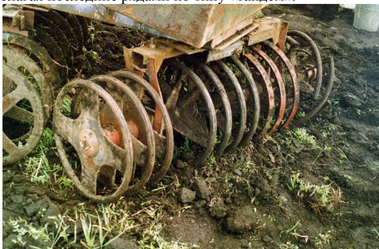
Рисунок 3 – Установка для исследования процесса взаимодействия обод-почва при различной форме ободьев экспериментальных катков.
